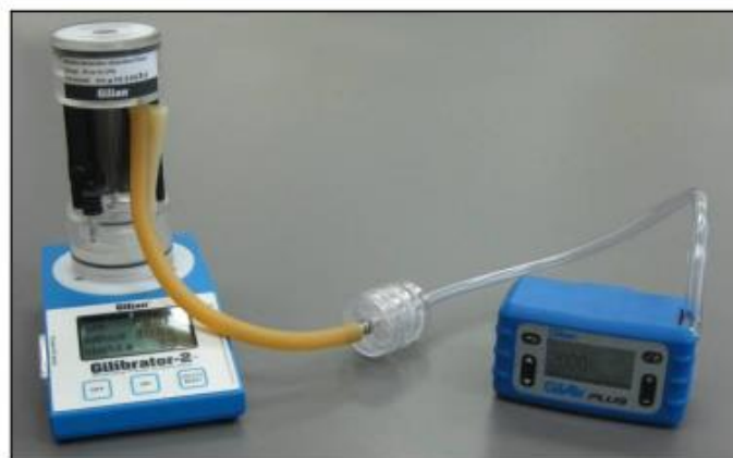
Imagen N° 03: Imagen extraída del manual, donde se muestra la bomba de muestreo, medio de captación (Filtro) y calibrador de burbuja.
