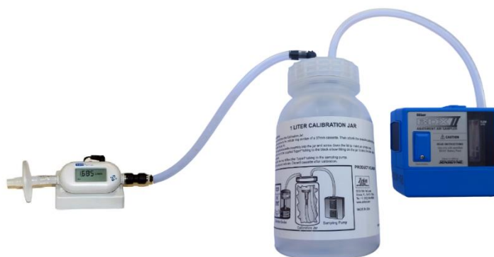
Imagen N° 04: Diagrama de calibración de una bomba de muestreo, cuando el muestreo involucre el uso de un ciclón (Aluminio, Nylon)
