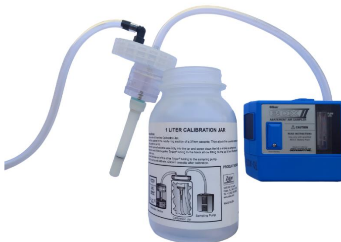
Imagen N° 05: Se muestra el montaje del ciclón de nylon (Torr Oliver), filtro de pvc, a la tapa de la jarra de calibración y esta a su vez conectada a la bomba personal de muestreo.
